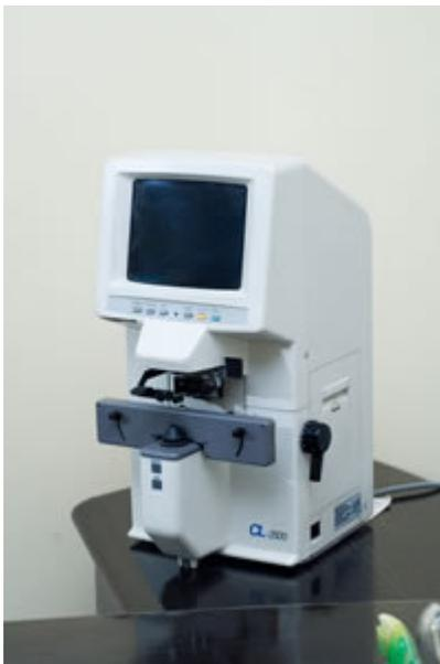
Frontofocometri per la lettura della lente in uso nel modo più preciso e moderno. La misurazione della lente resta sempre il primo atto di una visita oculistica. Il frontofocometro computerizzato permette una moderna e rapida lettura delle lenti anche progressive con la stampa dei risultati. In tal modo si ha un documento sicuro della correzione ottica della lente misurata nonché la distanza tra i centri ottici sia per vicino che per lontano.
